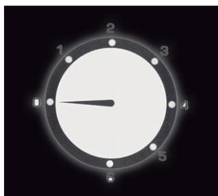
La temperatura interior varía desde 0° C a 10° C. Puede girar la manija del termostato para tener su temperatura deseada. Si gira la manija en sentido de las agujas del reloj, cuya posición varía de 1 a 6, puede obtener una temperatura inferior en el interior. Si gira la posición a 0, desactivará su dispositivo.
