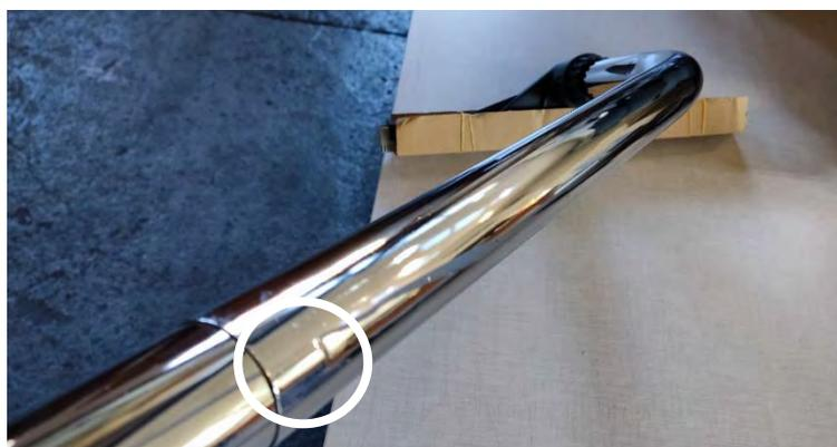
En el extremo corto del Tubo B, se coloca el conector en el que luego se enrosca la manguera flexible.
