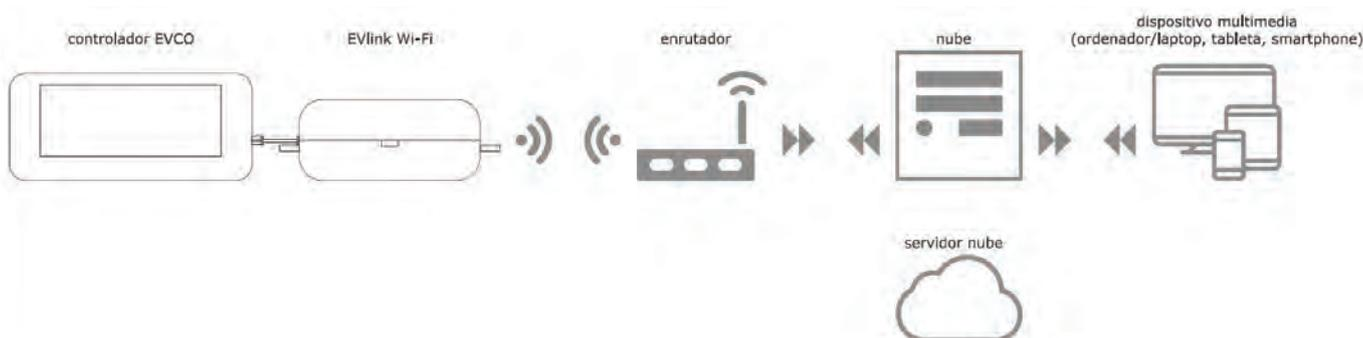
Todo lo que se necesita es una conexión a Internet Wi-Fi en el lugar dónde se encuentre el mueble para permitir que el controlador EVCO, utilizando un módulo EVlink Wi-Fi, se conecte al sistema en la nube, haciendo posible la gestión remota del equipo desde un ordenador, una tablet o un teléfono inteligente.
