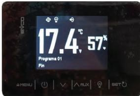
Trabajando en "manual" el operario debe estar pendiente del proceso porque debe ser él, el que se encargue de modificar la temperatura y la humedad a lo largo del proceso de curado. En este modo se controla la Tª y el %HR pero no el tiempo.
