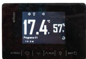
Para cada proceso y fase se pueden controlar la duración (tiempo), la temperatura (T), la humedad relativa (%HR) creando diferentes perfiles térmicos según el producto a tratar. Terminados los tres procesos la regulación procederá hasta parada manual.
