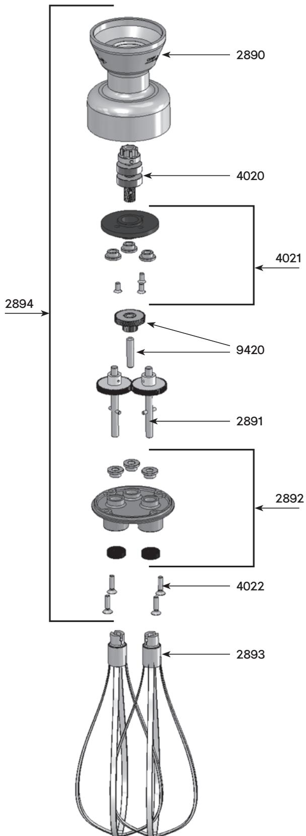
Desmontaje de las varillas
